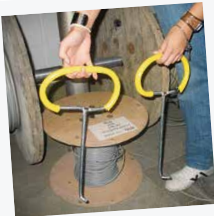
Selbst gebaute Tragehilfen für Kabelrolle
