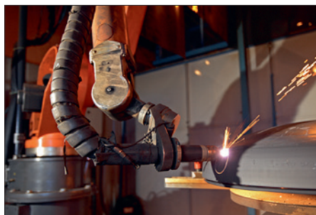
Feuerschalenproduktion – Industrieroboter zum verschweißen von Füßen und Griffen an die Feuerschale
