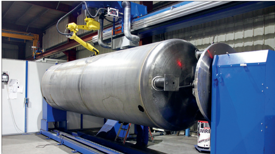
Großbehälterproduktion – Industrieschweißroboter für Rund- und Längsnaht
