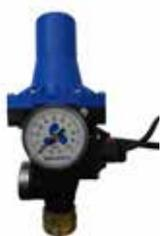
Der Druckschalter iController ist mit einer **Rückschlagklappe und einem Schlagdämpfer ausgestattet**. Ein zusätzliches Rückschlagventil an der Pumpe ist nicht notwendig. Der Schalter ist mit einem Schukostecker und einer Schukokupplung ausgerüstet, so dass keinerlei Eingriffe in die Pumpenleitung notwendig sind. Der Trockenlaufschutz sowie ein **Manometer zur Funktionskontrolle** sind ebenfalls integriert.
