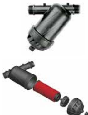
Disc-Filter schützen die Systemkomponenten der Wasserversorgungsanlage vor Funktionsstörungen, die durch Verschmutzungen im Brunnenwasser hervorgerufen werden. Im Gegensatz zu herkömmlichen Siebfiltern haben ewuaqua-Rillenscheibenfilter eine um ein Vielfaches größere Filteroberfläche, die die Filterung verbessert und die Anzahl der Reinigungsintervalle reduziert. Durch die gegenläufig angeordneten Rillen können auch kleinste Verunreinigungen bis 0,13 mm herausgefiltert werden.
