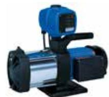
Kreiselpumpe als kompakter, vollautomatischer Hauswasserautomat mit Pumpensteuerung. Hauswasserautomat als selbstansaugende, mehrstufige Kreiselpumpe, inklusive Schaltautomat, korrosionsfrei, leiser und ruhiger Lauf. Ein-/Ausschaltautomatik mit Trockenlaufschutz. Gehäuse aus Edelstahl, anschlussfertig mit 1,5 m Kabel.
