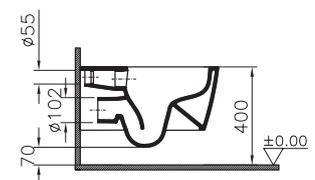
**Tiefspül-WC** wandhängend, mit verdeckter Befestigung, spülrandlos, mit Flush-Technologie.
