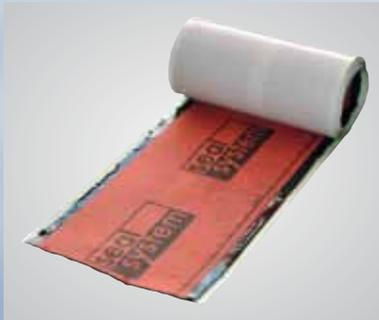
Das Seal System Dichtband für die Concept Duschrinnen. Das Butylkautschuk-Band wird überlappend verklebt und in die Verbundabdichtung eingearbeitet.
