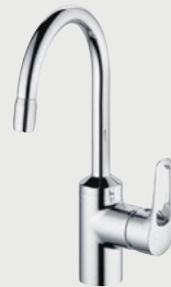
418510562-24 Spültisch-Einhandmischer DN 15 mit herausziehbarem Auslauf H1 340, H2 205, A 180, Ø1 34, Ø2 52
