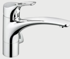
33696 .. 62-24 Spültisch-Multi-Einhandmischer DN 15 Anschluss für Wasch- oder Spülmaschine H1 225, H2 169, A 207, Ø1 34, Ø2 58 336970562-24 ⚡ für drucklose Speicher
