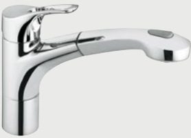
33691 .. 62-24 Spültisch-Einhandmischer DN 15 mit herausziehbarer Geschirrbrause H1 225, H2 153, A 225, Ø1 34, Ø2 58 336920562-24 ⚡ für drucklose Speicher
